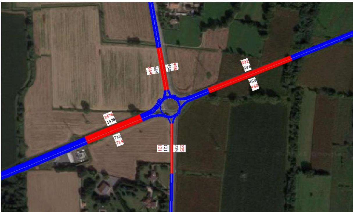
Figura 31 – Raffronto flussi rilevati (in rosso) e simulati (in nero) - HPM – dettaglio int. 2
