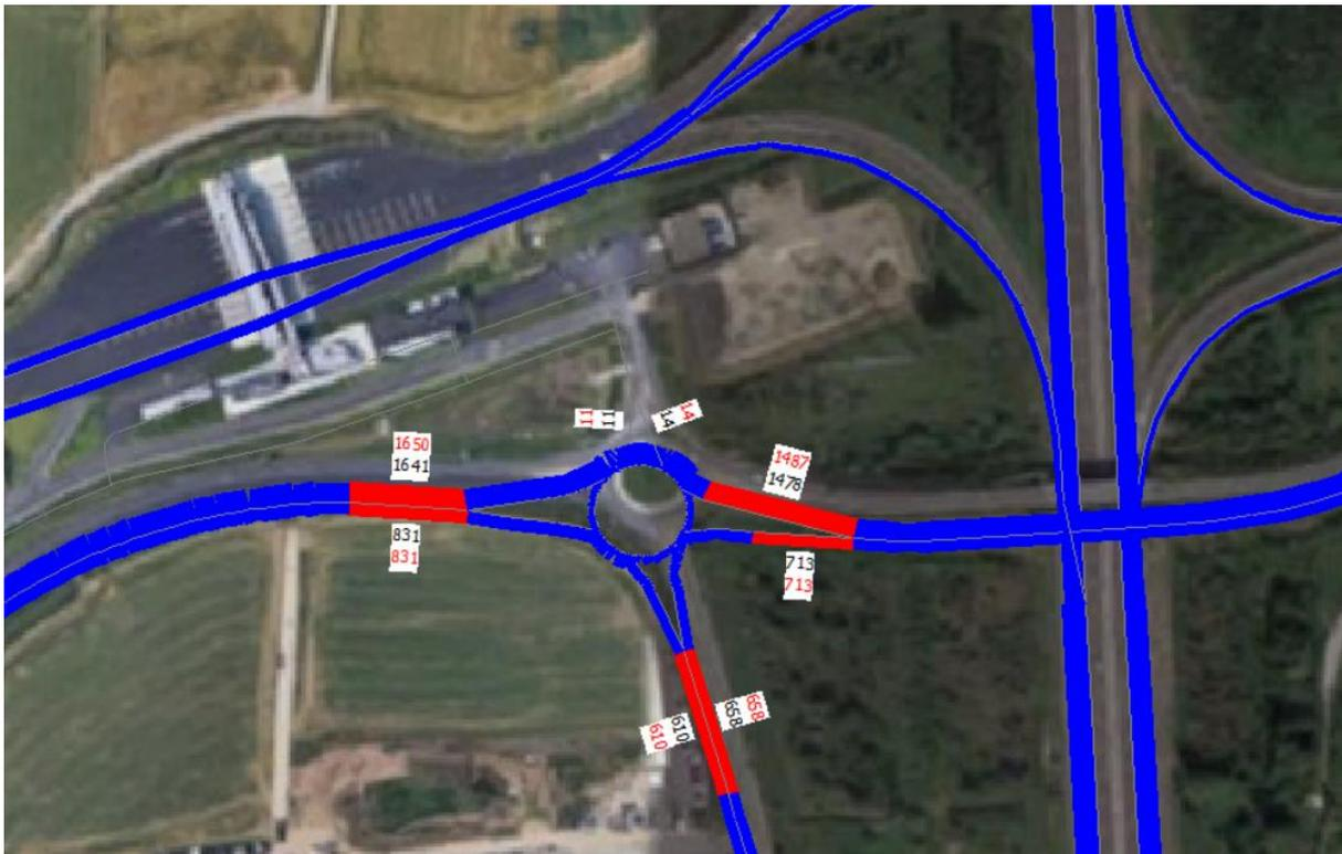
Figura 32 – Raffronto flussi rilevati (in rosso) e simulati (in nero) - HPM – dettaglio int. 3
