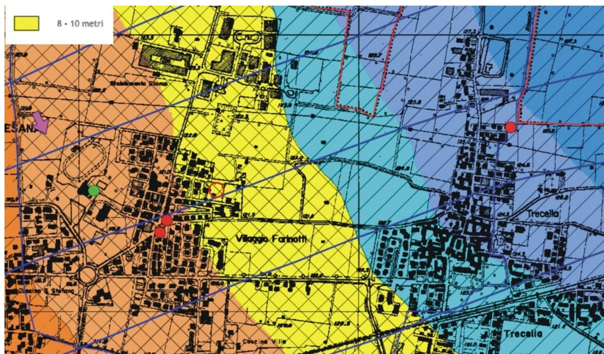
**Figura 8** Estratto della carta idrogeologica del PGT del Comune di Pozzuolo Martesana con linee isopiezometriche equidistanti 1 m
