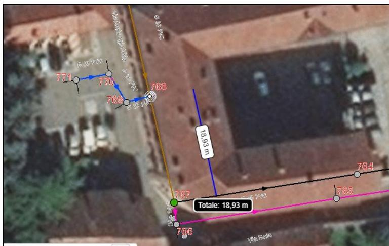
Fig. 2.7- Dettaglio proposta di disconnessione rete bianca di Via Villa con recapito in suolo attraverso pozzi drenanti
