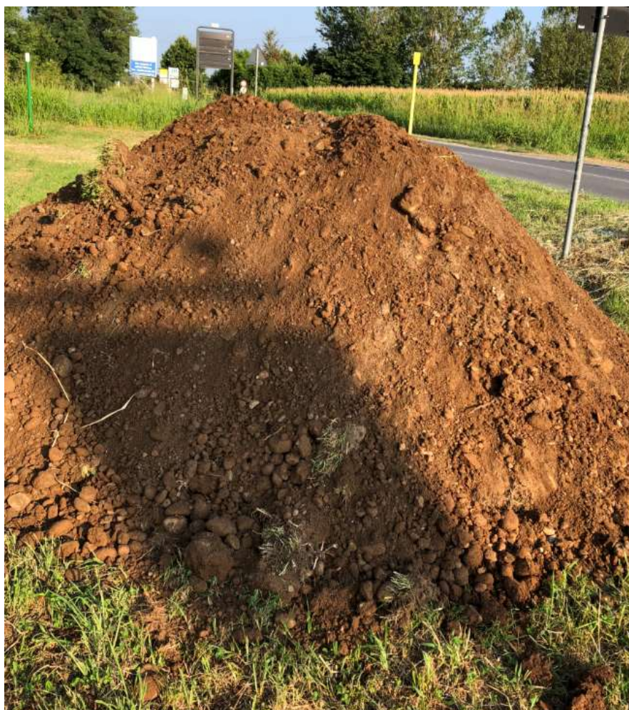
Figura 12 – Cumulo di sabbia limosa proveniente da scavo
